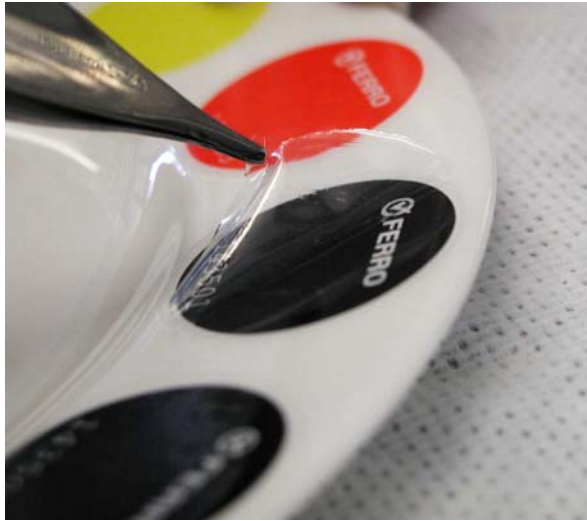
Abb. 1: Abziehen des Striplackes 80 2039
